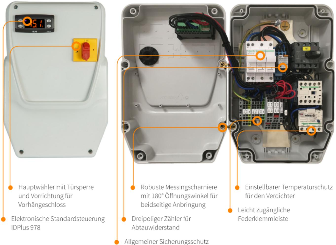
Produktlinie von Leistungsschalttafeln für die vollständige Steuerung von einphasigen oder dreiphasigen Kühlzellen, mit Direktsteuerung des Verdichters mit einstellbarem Temperaturschutz, Verdampfergebläse, Abtauwiderstand, Zellenbeleuchtung. Die Verwendung eines weit verbreiteten und bekannten Standardreglers wie dem IDPlus 978 machen die Inbetriebnahme und die Verwendung extrem einfach.
